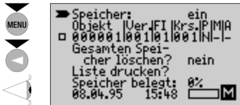
Sie können nun mit dem Prüfgerät die notwendigen Messungen durchführen. Die Messwerte werden jetzt automatisch im PSI-Modul gespeichert. Es spielt dabei keine Rolle, ob die Anzeige des Prüfgeräts zwischendurch erlischt. Die Aktivierung des Speichers bleibt erhalten. Wird das PSI-Modul jedoch vom Prüfgerät abgenommen und das Prüfgerät eingeschaltet, so wird nach der nächsten gültigen Messung die Speicherung deaktiviert („M“ erlischt).
